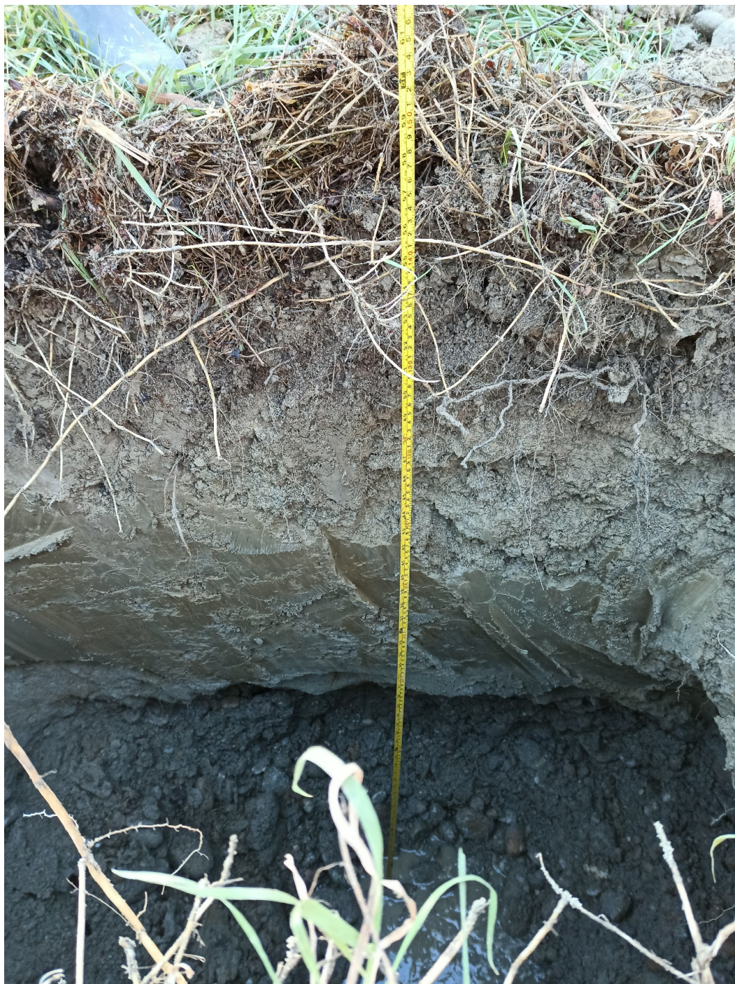
Pozzetto esplorativo BEL 53/P4. Si osserva bene il passaggio dalla porzione superiore del materasso alluvionale, costituita da un deposito fine, sabbioso-limoso, al sottostante deposito grossolano, ghiaioso – ciottoloso, che ne costituisce quella inferiore.
