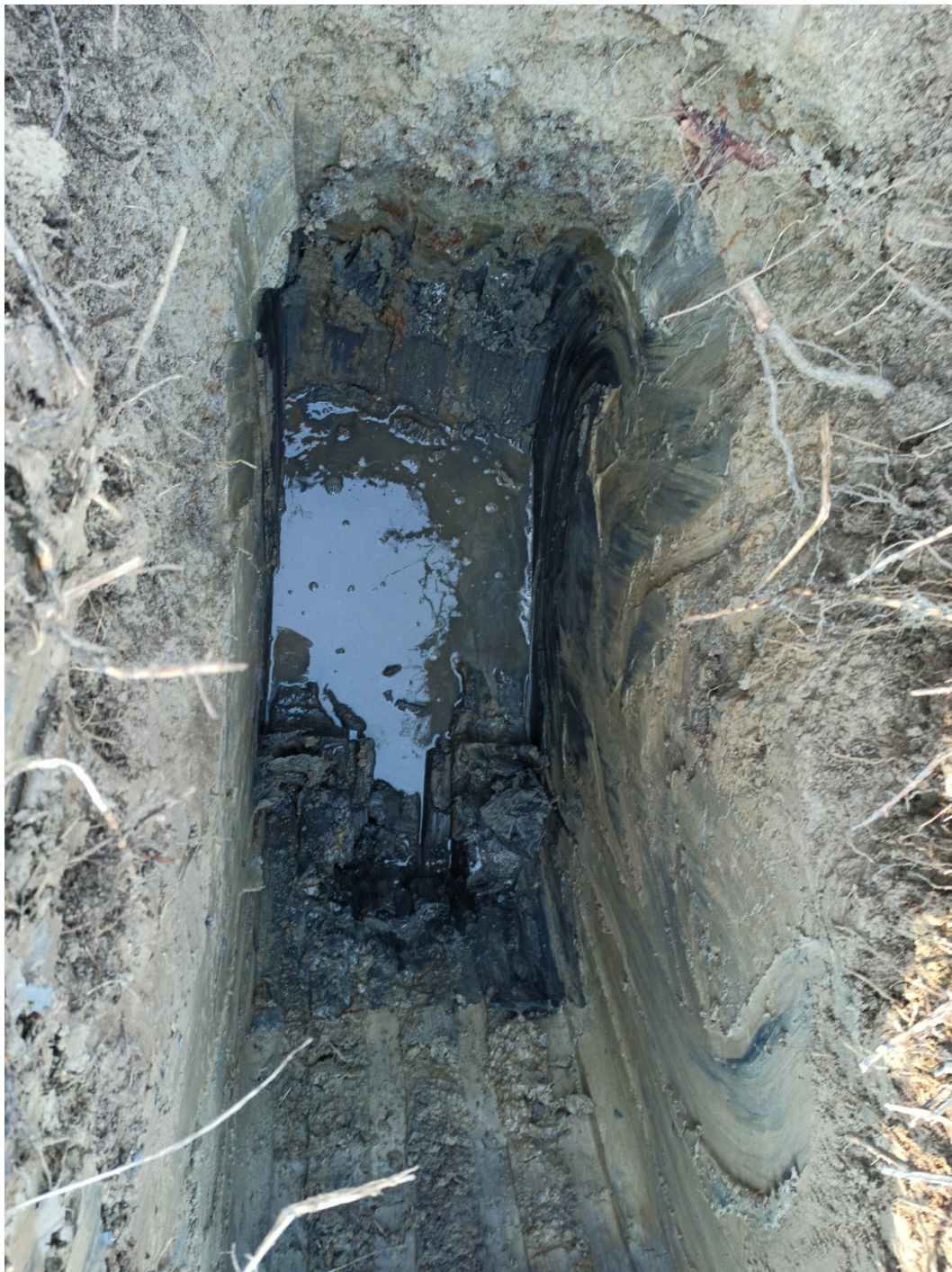
Pozzetto esplorativo BEL 53/P2. Si osserva, anche in questo caso, la presenza di un livello nerastro, riferibile ad una lente di argilla torbosa ( "Clay plug" ) formatasi nel contesto di meandri abbandonati, che hanno dato origine ad aree paludose (lanche) progressivamente interrate.
