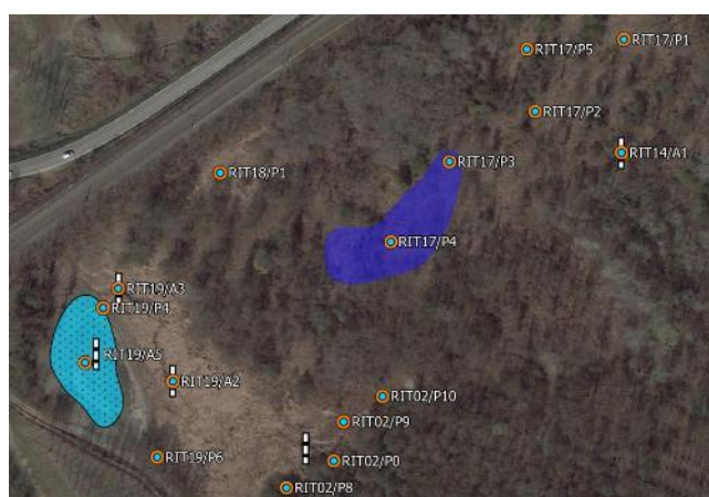
Figura 31: Rete di monitoraggio (aste idrometriche e piezometri) presenti nell'area di intervento.
