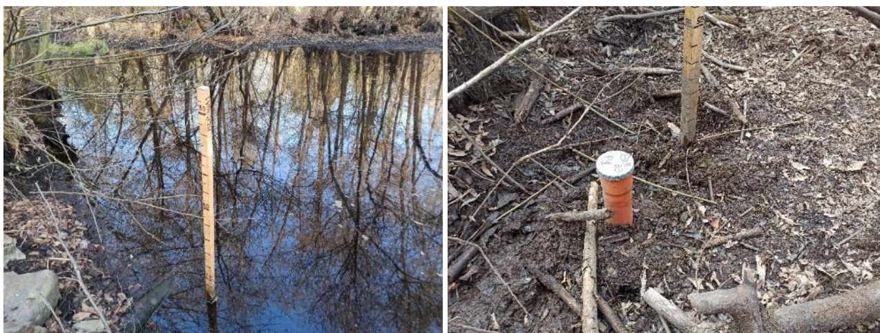
Figura 13: Dispositivi per il monitoraggio idrologico (asta idrometrica graduata a sinistra e piezometro a destra).
